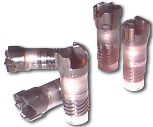
Recubrimiento tribológico. Brocas recubiertas con carburo de molibdeno
