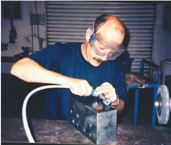
Preparación superficial de piezas. Desbaste
