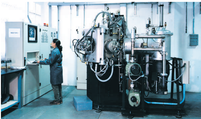
Reactor P.V.D en TTC. Evaporación por arco catódico
