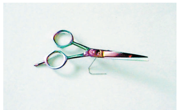
Recubrimiento decorativo. Tijeras recubiertas con TiN y óxidos metálicos
