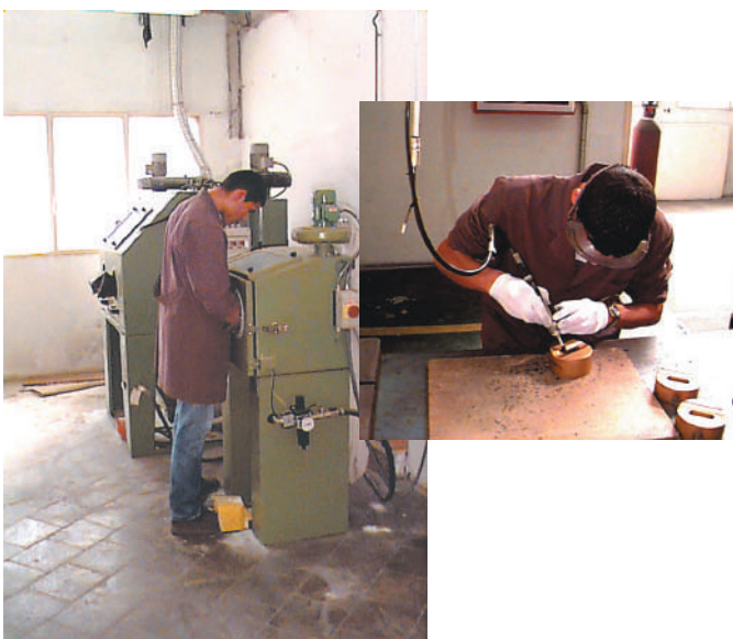
Preparación superficial de piezas. Arenado y pulido
